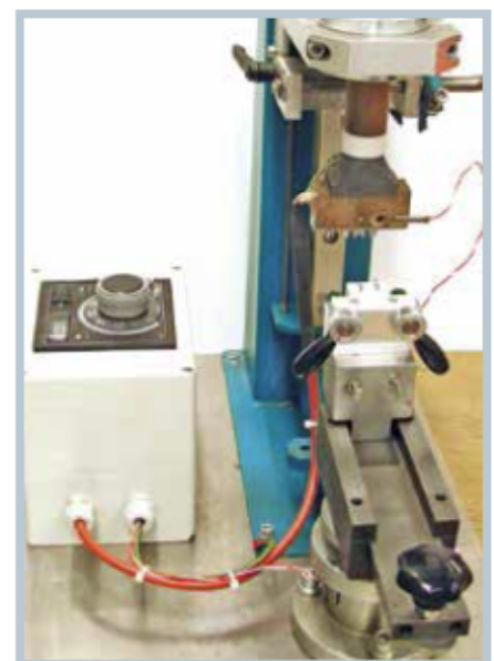
Bild 3. Vorrichtung zum thermischen Schweißen von Einzelfasern. Durch das Schweißen wird verhindert, dass sich die einzelnen Fasern während der Fertigung verschieben (Bild: V. D. Ledermann)
