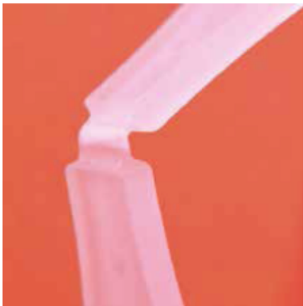
Bild 1. Bei Filmgelenken verbindet ein dünner Film die zueinander beweglichen Gelenkhälften (Bild: TU Dresden / IFTE)
