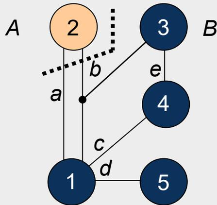
2. Gewinnwert aktualisieren von allen verschiebbaren Zellen, die mittels kritischer Netze mit Zelle 1 verbunden sind:
