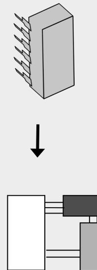
Die Aufgabe der Partitionierung besteht darin, eine Schaltung in Teilschaltungen, sog. Partitionen oder Blöcke, aufzuteilen (zu partitionieren), wobei die Verknüpfungen der Blöcke untereinander zu minimieren sind.
