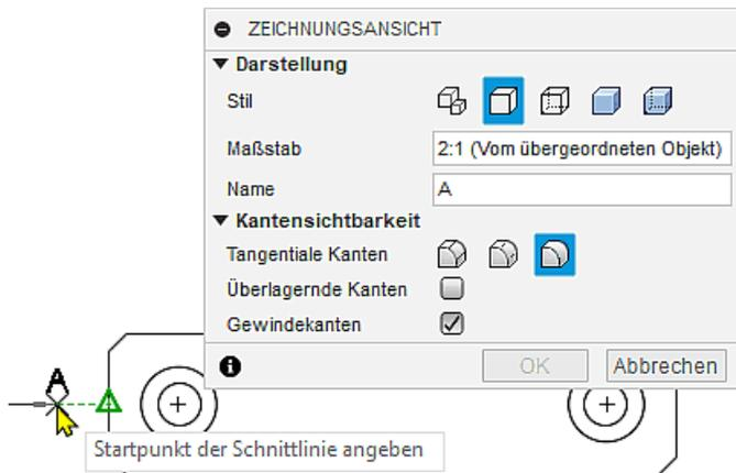
3. An der gegenüberliegenden Körperkante setzt man den zweiten Endpunkt der Schnitlinie genauso:
