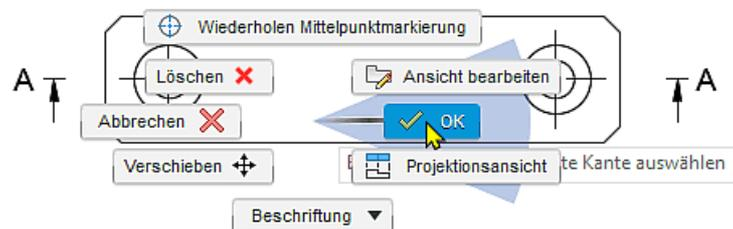
**Zeichnung > Geometrie > Mittellinie** ermöglicht die Definition der Mittel- bzw. Symmetrielinien:
