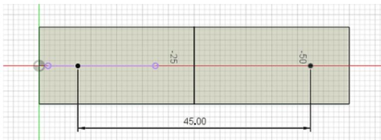
Nach der Definition der beiden Bohrpunkte können wir die "**Skizze fertig stellen**" und weiter am Volumenkörper arbeiten:
