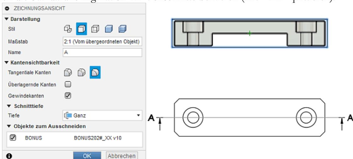
**Hinweis:** Beim Erstellen dieser Anleitung wurde im Ergebnis die Schnittlinie zwischen den beiden Endpunkten nicht dargestellt. Dies ist im Beispiel nicht so schlimm, da die Schnittlinie deckungsgleich mit der Symmetrielinie verläuft, welche wir später noch ergänzen.
